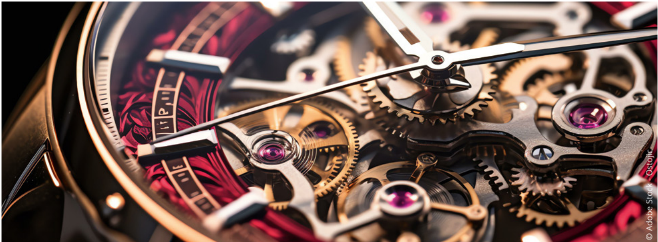
Das Werk einer mechanischen Uhr mit Zugfeder, Anker und Unruhspirale: Die Hemmung verhindert eine plötzliche Entspannung der Feder
